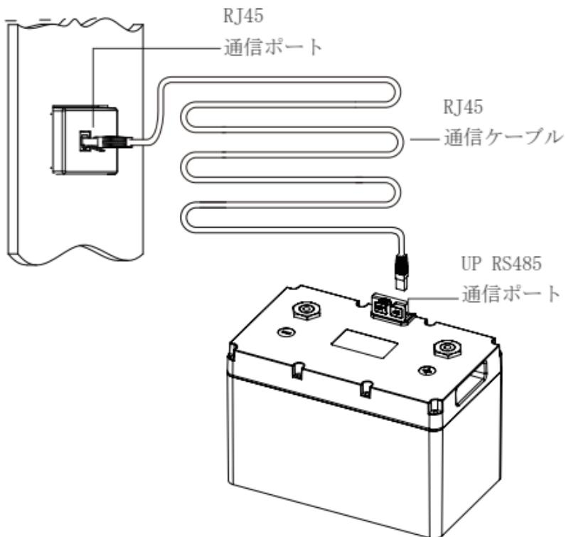
複数の並列バッテリーを監視する場合、バッテリー同士を繋ぐCAT5以上のLANケーブルを別途購入する必要があります。通信ケーブルを使用し、バッテリー間のLINK RS485 通信ポートとUP RS485 通信ポートを接続してください。
